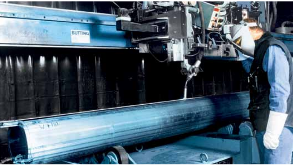
Herstellung einer Ofenrolle aus Nicrofer® 6025HT/ alloy 602CA mit CRONIGON® Ni30. (Quelle: H. BUTTING GmbH & Co. KG)
