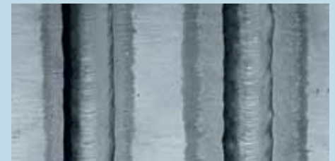
Lichtbogenstabilisierung durch VARIGON® S (links) im Vergleich zu Argon (rechts)
