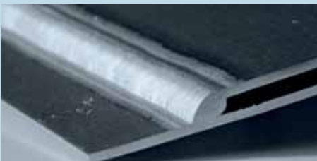
1,5 mm Spaltüberbrückung am Überlappstoß von 1-mm-Blechen, MIG-AC-geschweißt mit VARIGON® He15S und 1,2-mm-Drahtelektrode
