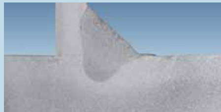
Richtungsstabilität des MIGp-Lichtbogens unter VARIGON® He30S vereinfacht „Dick-dünn-Verbindung“, hier 3 mm an 8 mm
