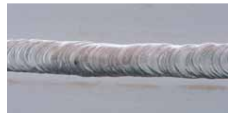
WIG-Naht, Wurzelseite formiert
