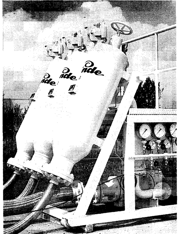
Bild 2 — Stickstoff-Strahlmittel-Mischer für das GANBLOW®-Verfahren
