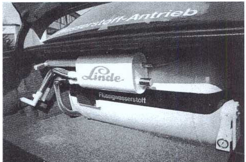
Bild 5 LH 2 -Treibstofftank in einem BMW 735
