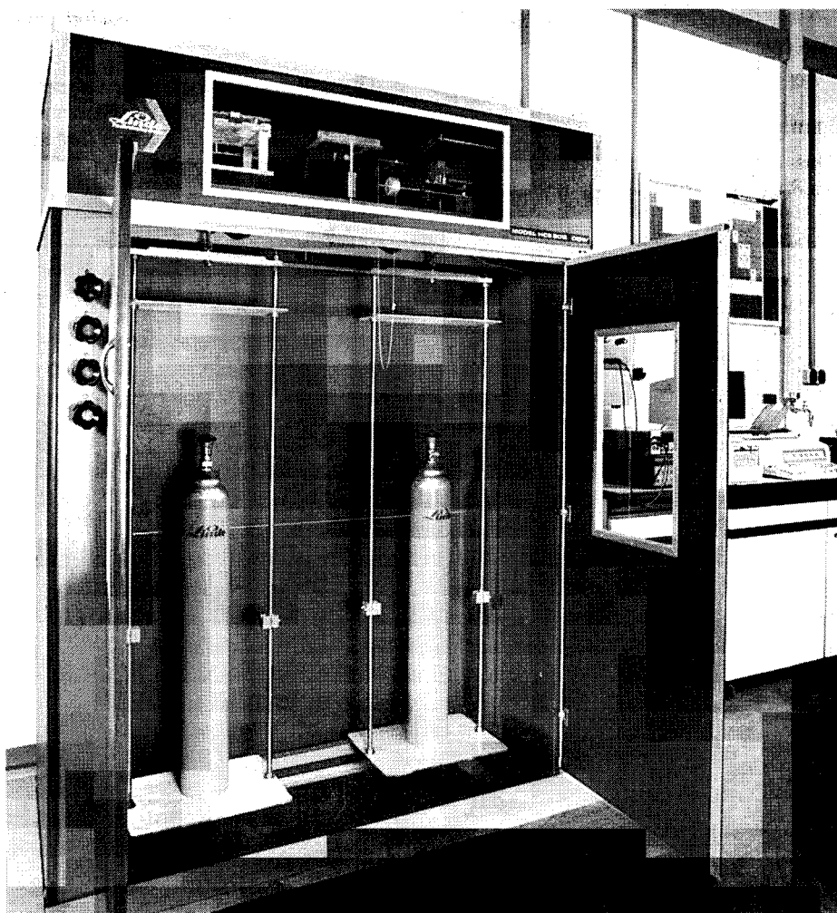
Bild 2 — Präzisionswaage (Balkenwaage) zur gravimetrischen Prüfgasherstellung
