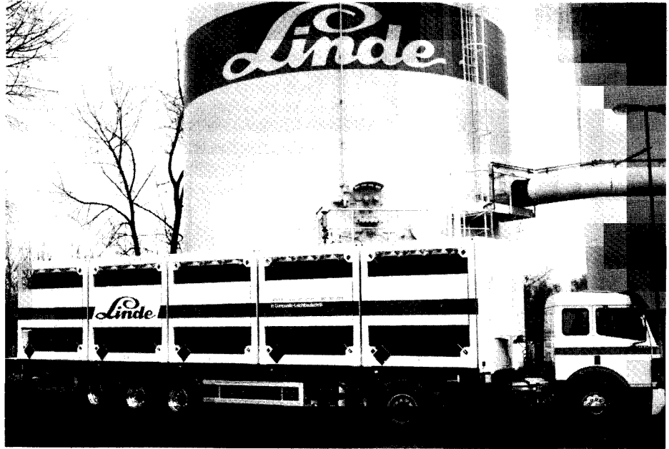
Bild 4 — Größter Druckgasflaschen-Trailer der Welt in Composite-Leichtbautechnik
