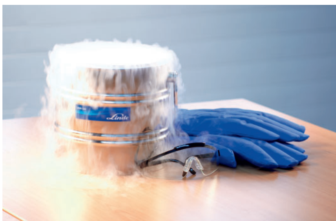
Abbildung 17 & 18: Persönliche Schutzausrüstung für die Arbeit mit Gasen bei Tieftemperaturbehandlungen
