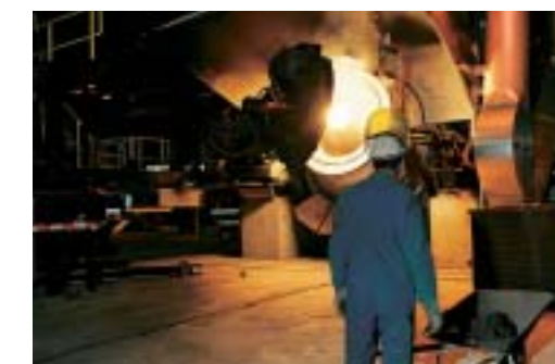
Mit URTF und reinem Sauerstoff steigerte Stena Aluminium seine Fertigungskapazität um 50 Prozent. Mit seinen beiden URTF-Schmelzöfen in Älmhult (Schweden) kann das Unternehmen aus Aluminiumschrott jetzt jährlich 50.000 Tonnen hochwertiges Gussaluminium herstellen.
