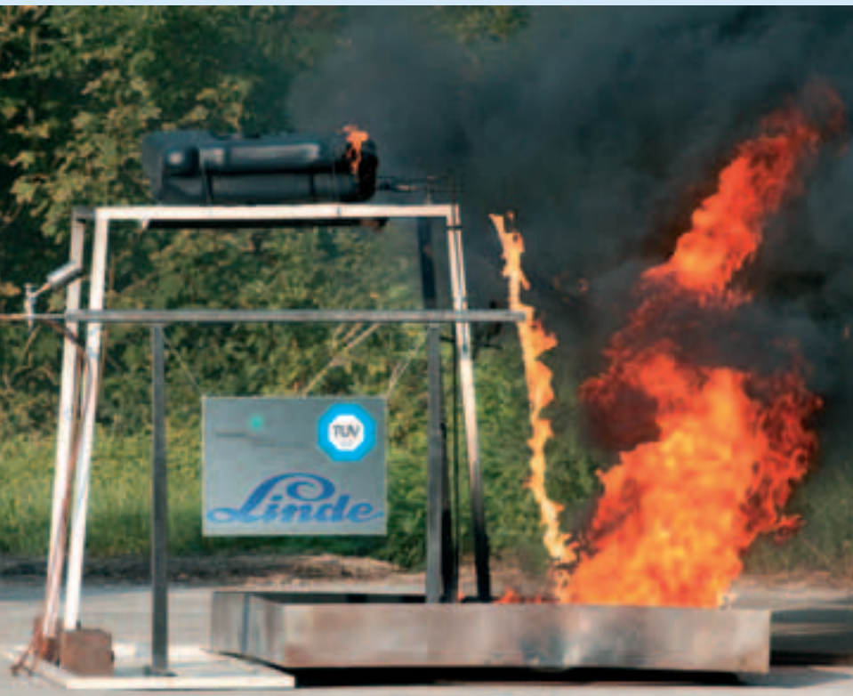
Benzin brennt im Gegensatz zu Wasserstoff flächig und langsam ab. Es entsteht schwarzer Rauch und in der Umgebung große Hitze. Selbst wenn die Benzingleitung geschlossen wird und der Strahl rechts neben dem Ständer versiegt, brennt das Benzin in der Auffangwanne weiter.
