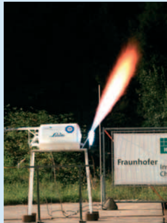
Wasserstoff brennt sehr schnell und aufgrund seiner geringen Dichte steil nach oben ab. Die Wasserstoff-Flamme ist nachts gut sichtbar, tagsüber ist sie an der „flirrenden“ Luft erkennbar. Sobald die Leitung geschlossen wird und kein Wasserstoff mehr auströmt, erlischt die Flamme.
