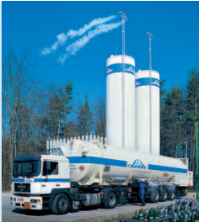
Moderne, doppelwandig isolierte Flüssigwasserstoff-Trailer transportieren bei weniger als 40 Tonnen Gesamtgewicht 3.370 Kilogramm Wasserstoff – das ist etwa zehn Mal mehr als die herkömmlichen Trailer für unter Druck gespeicherten Wasserstoff fassen.
