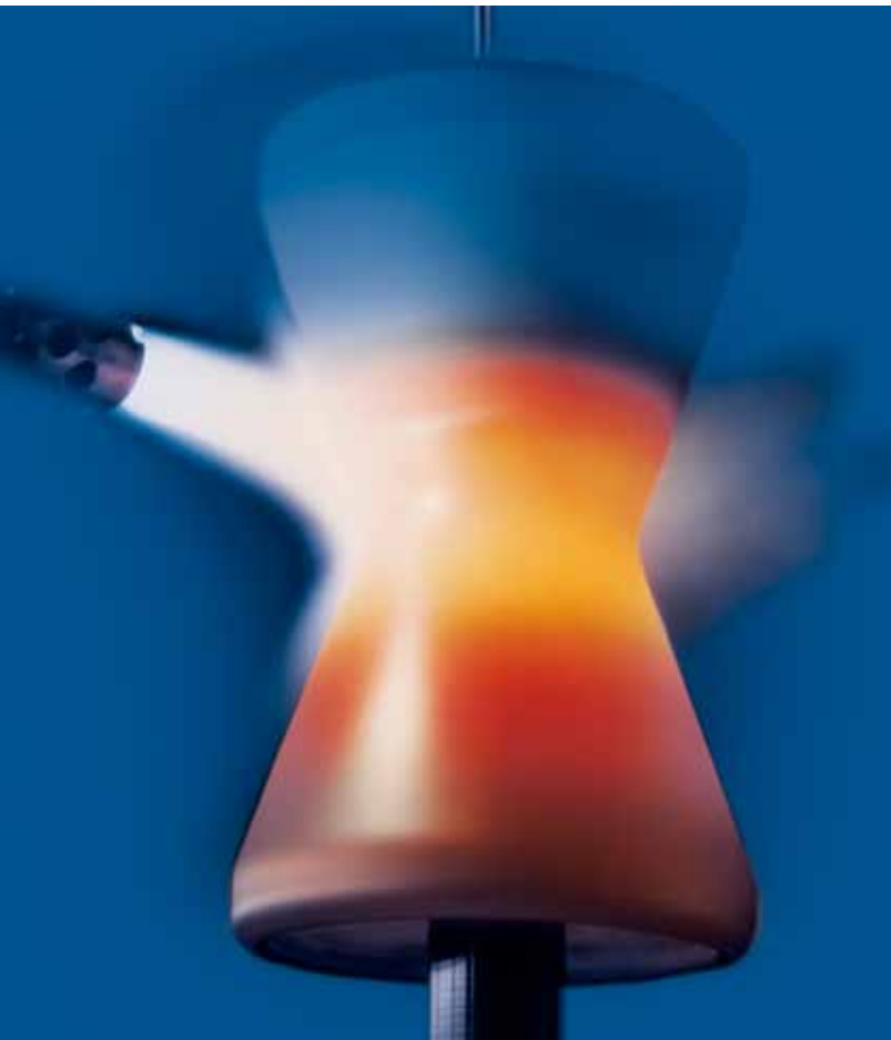
Seil-Umlenkrolle beim automatischen Einschmelzen der durch das Pulver-Flammspritzverfahren aufgetragenen CrNi BoSi-Legierung
