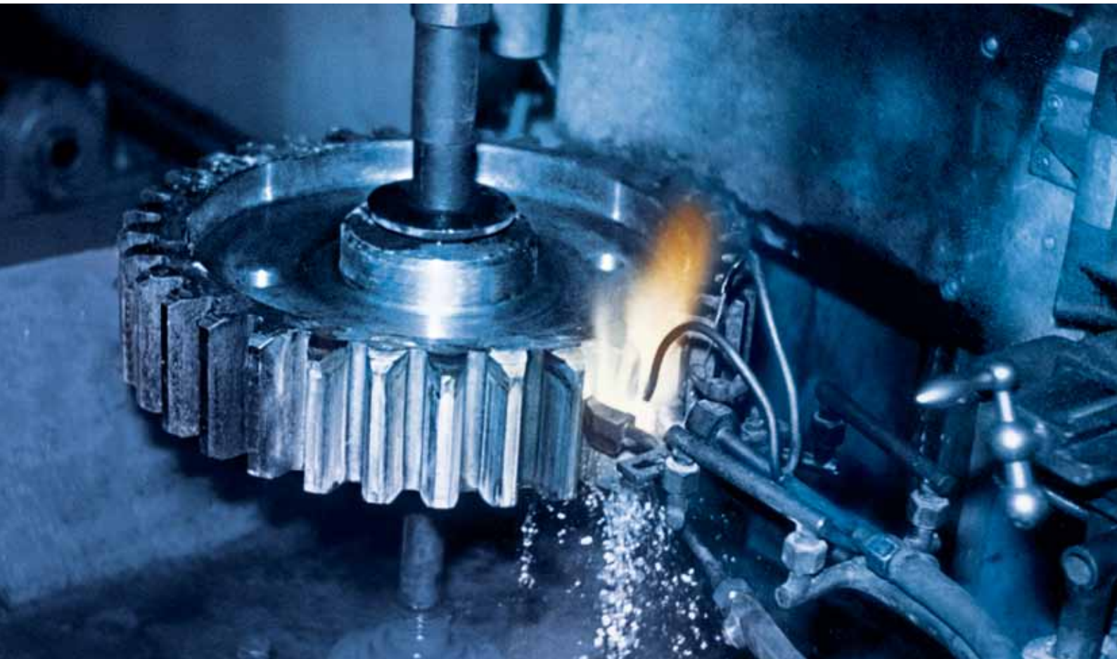
Sonderbrenner zum Flammhärten mit Wasserkühlung.
