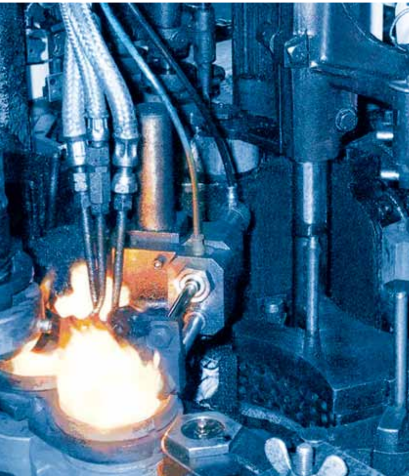
Kohlenstoff-Beschichtung einer Glasform mit CARBOFLAM® in der Hohlglasherstellung
