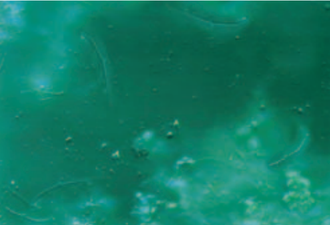
Schwach strukturierte Flockenmorphologie durch ungenügende Sauerstoffversorgung in der Betriebskläranlage einer Brauerei.
