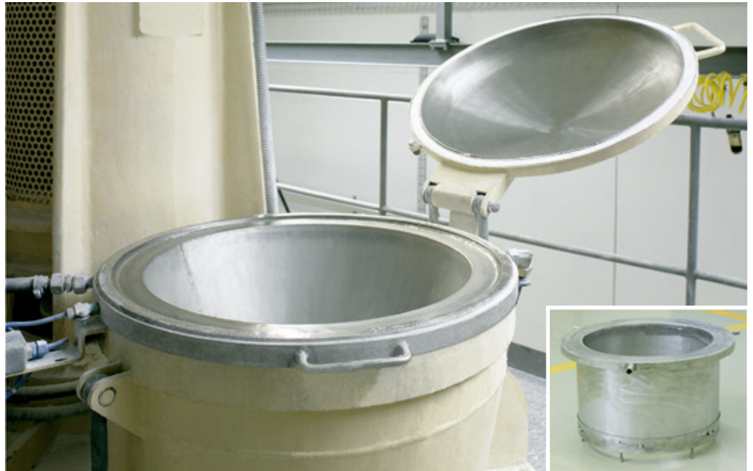
N2LOCK®-System adaptiert an der Einfüllöffnung eines Rührbehälters von 2.000 kg Kapazität.
