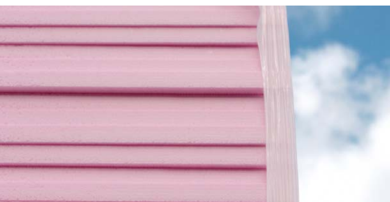
Mit \text{CO}_2 geschäumte XPS-Platten
