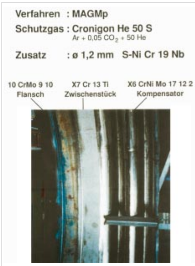
Bild 17 Abgas-Diffusor für Gasturbinen, Werkstoffkombinationen
