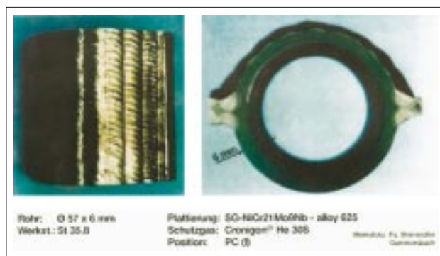
Bild 19 Plattieren von Flossenrohren
